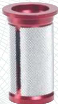
NUOVO EXPANDER DA 45MM IN ALLUMINIO 6061. COMPATIBILE CON IL MONTAGGIO DI ATTACCHI E SERIE STERZO SU FORCELLE DA 1 1/8" CON DIAMETRO INTERNO DA Ø 23,6 A 24,1 MM. COLORE ROSSO ANODIZZATO. PESO 32 GRAMMI.
