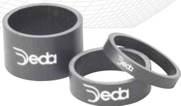
REALIZZATI IN FIBRA DI CARBONIO UNIDIREZIONALE CON FINITURA A VISTA. COMPATIBILE CON SERIE STERZO DA 1 1/8" E CON FORCELLA CON CANNOTTO Ø 28,6 MM. SPESSORI CON DIAMETRO ESTERNO Ø 33,5 MM; Ø INTERNO 28,85 MM. DISPONIBILI IN ALTEZZA 3-5-10-15-20 MM.
