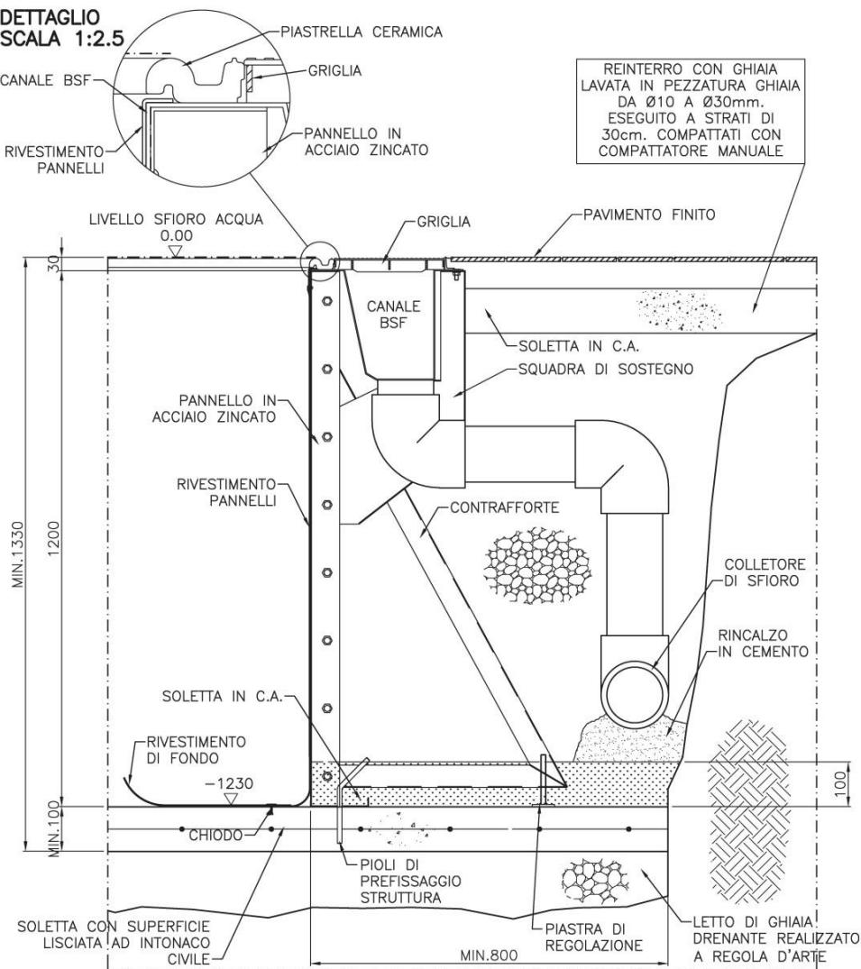
N.B.: I PANNELLI E I CONTRAFFORTI VENGONO POSTI IN OPERA TRAMITE I PIOLI DI PREFISSAGGIO. ESEGUIRE IL GETTO DI FISSAGGIO CONTRAFFORTI SPESSE 100mm. ESEGUIRE IL REINTERRO NELLE MODALITA' SOPRA INDICATE E COMUNQUE NON PRIMA DI 48 ORE DAL GETTO DI FISSAGGIO CONTRAFFORTI.
