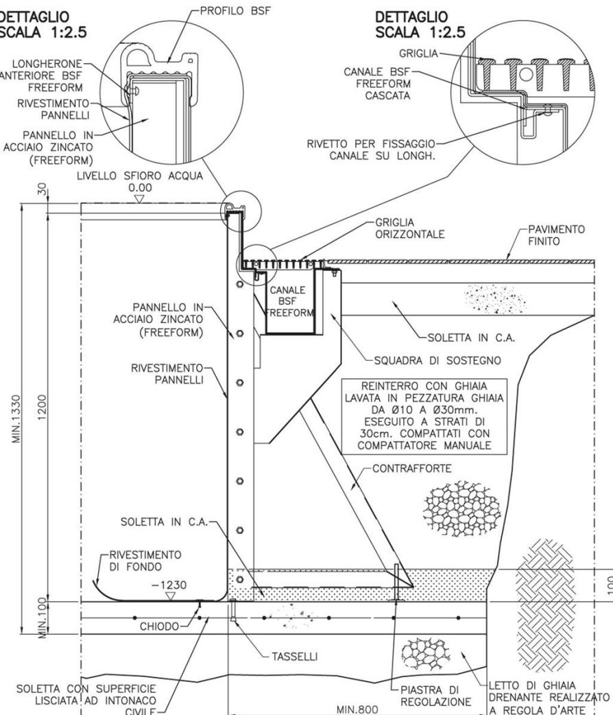
N.B.: I PANNELLI E I CONTRAFFORTI VENGONO POSTI IN OPERA TRAMITE I PIOLI DI PREFISSAGGIO. ESEGUIRE IL GETTO DI FISSAGGIO CONTRAFFORTI SPESSESSORE 100mm. ESEGUIRE IL REINTERRO NELLE MODALITÀ SOPRA INDICATE E COMUNQUE NON PRIMA DI 48 ORE DAL GETTO DI FISSAGGIO CONTRAFFORTI.
