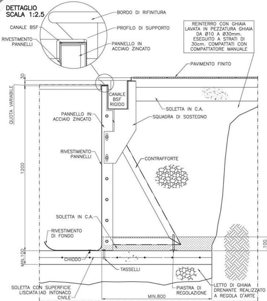
N.B.: I PANNELLI E I CONTRAFFORTI VENGONO POSTI IN OPERA TRAMITE I PIOLI DI PREFISSAGGIO. ESEGUIRE IL GETTO DI FISSAGGIO CONTRAFFORTI SPESSEORE 100mm. ESEGUIRE IL REINTERRO NELLE MODALITA' SOPRA INDICATE E COMUNQUE NON PRIMA DI 48 ORE DAL GETTO DI FISSAGGIO CONTRAFFORTI.
