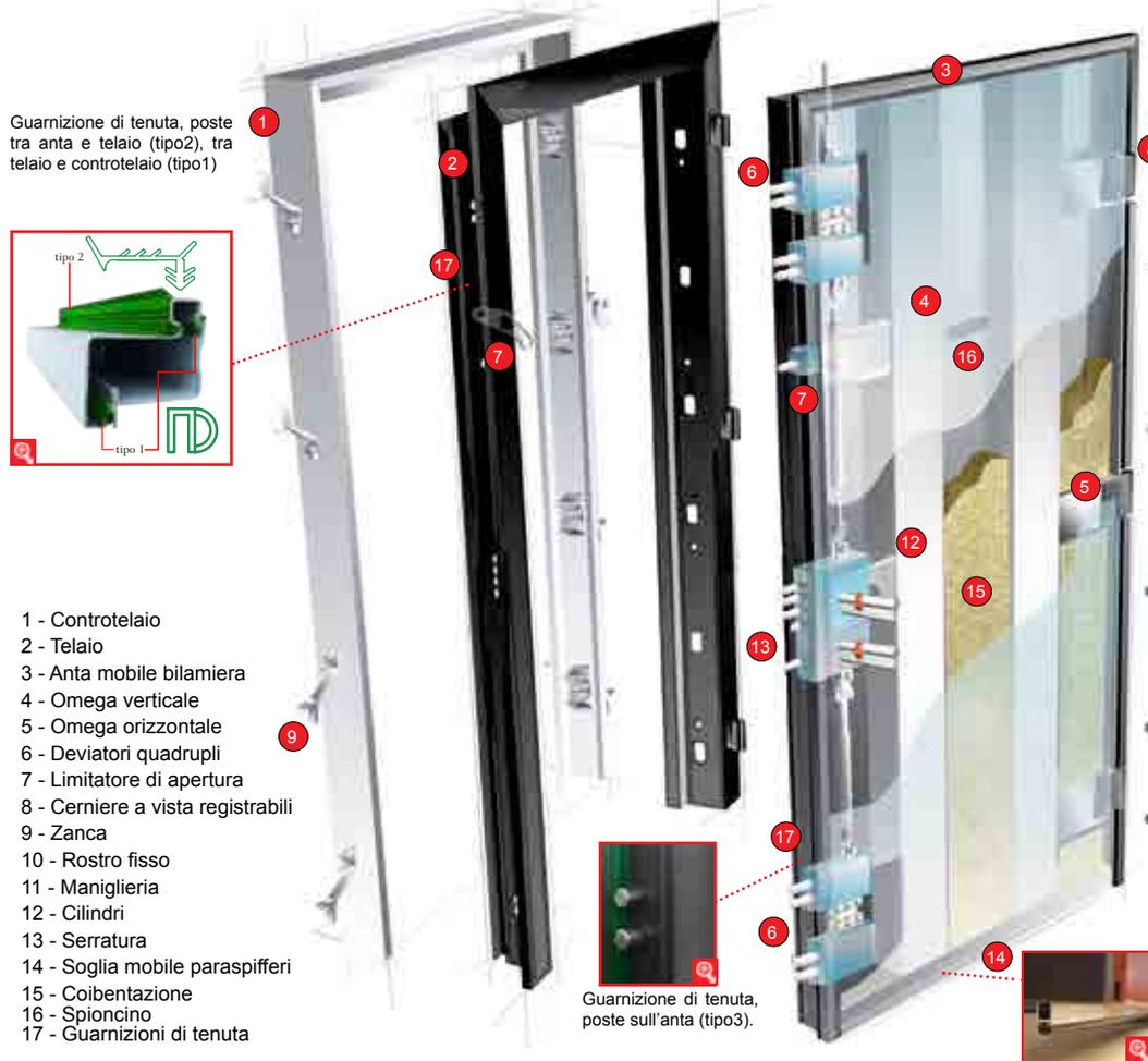
Guarnizione di tenuta, poste tra anta e telaio (tipo2), tra telaio e controtelaio (tipo1)
