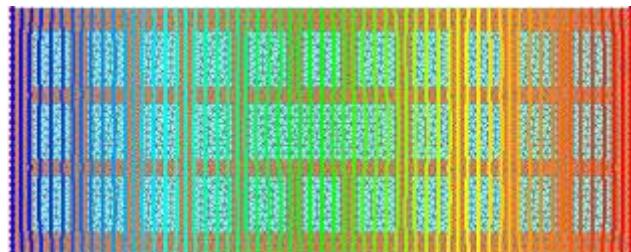
La valutazione della resistenza termica delle cavità d'aria, analizzate con il sistema degli elementi finiti, ha seguito i criteri della norma UNI EN ISO 6946:2007
