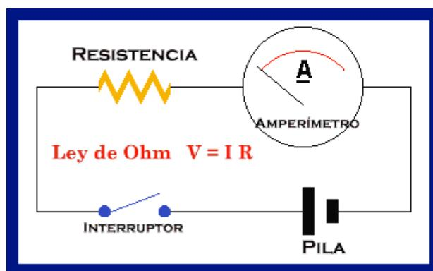
De este modo, para una tensión de 20 V, a la cual se le aplica una resistencia de  $8\Omega$ , se obtiene una corriente de 2.5 amperes.
