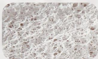
2 Strato intermedio in **Labir-tec**, reticolato ad altissima traspirazione di nuova generazione, densità  $80 \text{ kg/m}^3$ .
