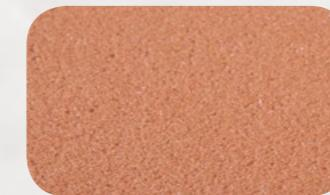
3 Strato antibatterico in **Memory Sanity**, densità  $50 \text{ kg/m}^3$  MEDIUM.
