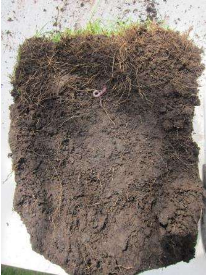
Na 8 cm diepte sterk verdicht grond
