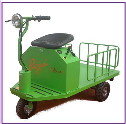
a terra cm. 151x74 con piano di carico utile cm. 95x74, autonomia 5 ore in continuo, batterie piombo acido/gel fanale anteriore, luci posteriori, clacson, freno a tamburo anteriore, freno a disco posteriore, freno di stazionamento, chiave di accensione, di pulsante sicurezza uomo a bordo, indicatore stato di carica delle batterie, leva selezione marcia avanti, folle e retromarcia, innesto rapido carica batterie esterno, leva per stacco immediato batterie, delle gomme super elastiche.
