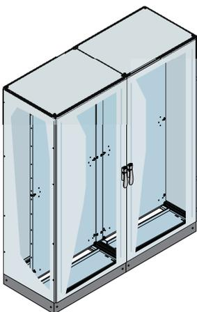
N°2 strutture montate serie IS2 dimensioni 2000x800x600mm (2105x1604x610mm HxLxP esterne) IP65 con porta cieca, piastra di montaggio, pannelli laterali, flange ingresso cavi scorrevoli, kit di unione strutture/piastre e zoccolo H=100mm (flange incluse).
