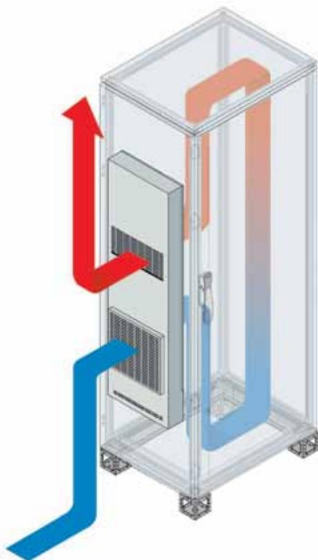
Poiché la temperatura interna è minore della temperatura esterna, il calore si trasmette dall'esterno verso l'interno del quadro.
