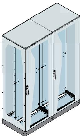
N°2 strutture montate serie IS2 dimensioni 2000x600x600mm (2105x1204x610mm HxLxP esterne) IP65 con porta cieca, piastra di montaggio, pannelli laterali, flange ingresso cavi scorrevoli, kit di unione strutture/piastre e zoccolo H=100mm (flange incluse).
