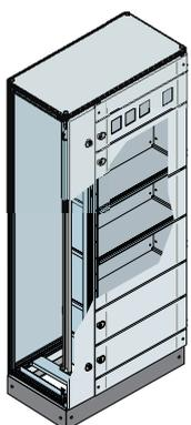
Struttura montata serie IS2 dimensioni 1800x800x400mm (1805x794x410mm HxLxP esterne) IP41 versione a celle segregate Forma 3, risalita cavi L=200mm, con pannello strumenti e porte cieche per PC-MCC, zoccolo H=100mm (flange incluse).
