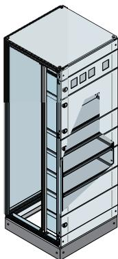
Struttura montata serie IS2 dim. 1800x600x600 (1805x594x610mm HxLxP esterne) IP41 versione a celle segregate Forma 3, con pannello strumenti e porte cieche per PC-MCC, zoccolo H=100mm (flange incluse).
