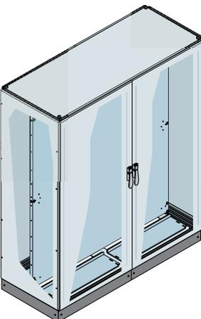
Struttura montata serie IS2 dimensioni 2000x1600x600mm (2105x1610x610mm HxLxP esterne) IP65 con porta cieca, piastra di montaggio, pannelli laterali, flange ingresso cavi scorrevoli e zoccolo H=100mm (flange incluse).
