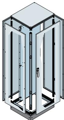
Struttura in kit serie IS2 dimensioni 2000x600x500mm (2105x610x510mm HxLxP esterne) IP65 con porta cieca, piastra di montaggio, pannelli laterali, zoccolo e flange H=100mm (flange ingresso cavi escluse).
