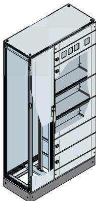
Struttura montata serie IS2 dimensioni 1800x1000x400mm (1805x994x410mm HxLxP esterne) IP41 versione a celle segregate Forma 3, risalita cavi L=400mm, con pannello strumenti e porte cieche per PC-MCC, zoccolo H=100mm (flange incluse).
