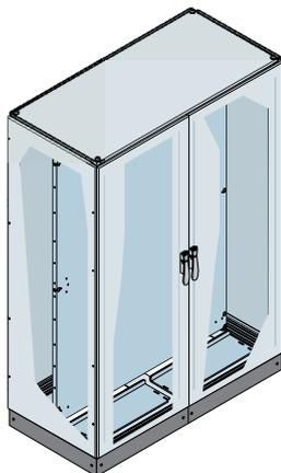
Struttura montata serie IS2 dimensioni 2000x1200x600mm (2105x1210x610mm HxLxP esterne) IP65 con porta cieca, piastra di montaggio, pannelli laterali, flange ingresso cavi scorrevoli e zoccolo H=100mm (flange incluse).
