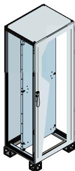
Struttura montata serie IS2 dimensioni 1800x600x400mm (1905x594x410mm HxLxP esterne) IP65 con porta cieca, piastra di montaggio e zoccolo H=100mm (pannelli laterali, flange ingresso cavi e flange zoccolo escluse).
