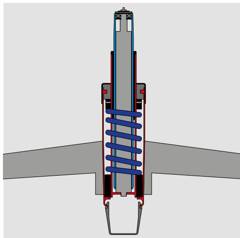
**Meccanismo Sedo-Lift.** Questa regolazione dell'altezza, brevettata a livello mondiale, assicura un lieve molleggio anche nella posizione di seduta più bassa senza stress per la schiena. Una molla d'acciaio ammortizza il movimento al momento della seduta. L'altezza del sedile viene bloccata grazie ad un sistema idraulico. In questo modo si alleggerisce il carico sulla cartuccia a gas, che risulta quindi molto più durevole. Per questo motivo Sedus fornisce una garanzia di 30 anni.
