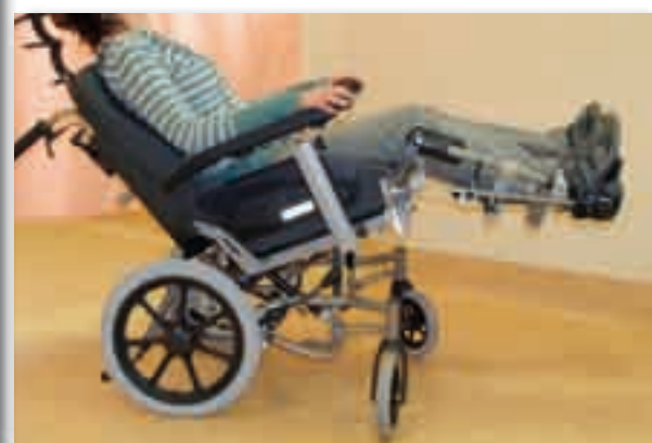
Fig.7 carrozzina basculante cambio di posizione da seduto a semisdraiato
