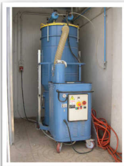
Aspiratore industriale con sistema di filtrazione a cartucce e pulizia automatica ad aria compressa.
