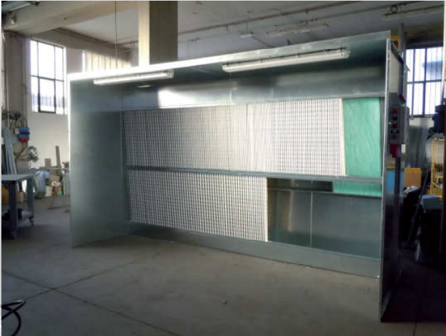
Cabina di verniciatura a secco con filtro ANDREA, PAINT-STOP e carboni attivi.
