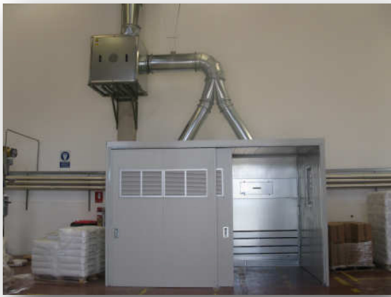
Cabina aspirante con parete filtrante a cartucce con puli- zia pneumatica per polveri pericolose.
