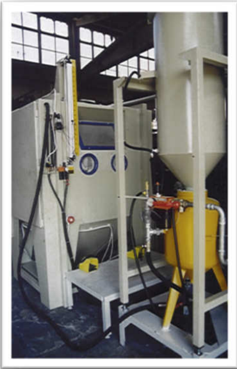
Cabina di sabbatura automatica e manuale a pressione.
