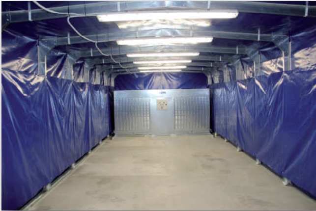
Cabine di sabbatura e verniciatura mobili.
