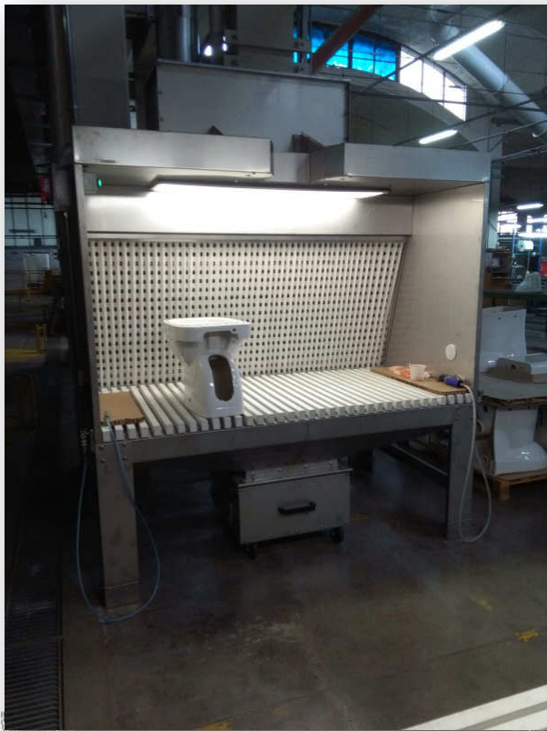
Cabina aspirante con filtro ANDREA E e carboni attivi per polveri fini.
