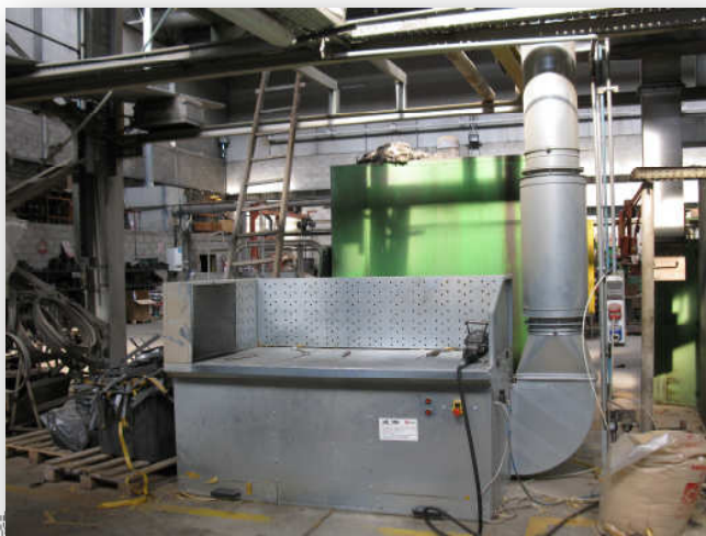
Banco aspirante con cartucce autopulenti inserite all'interno.
