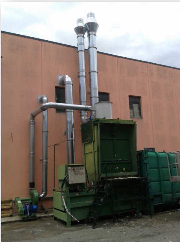
Separatore a ciclone direttamente collegato alla pressa.
