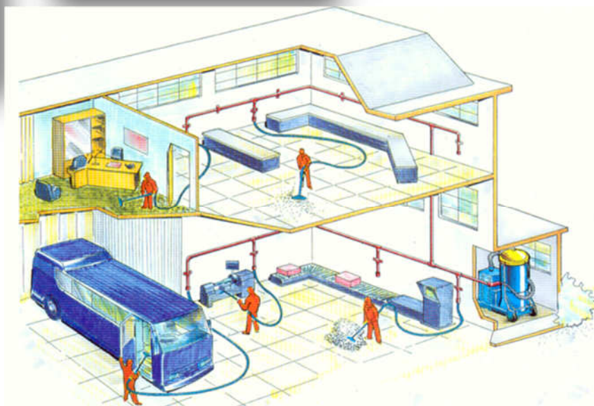
Impianto aspirazione centralizzato con ciclone.
