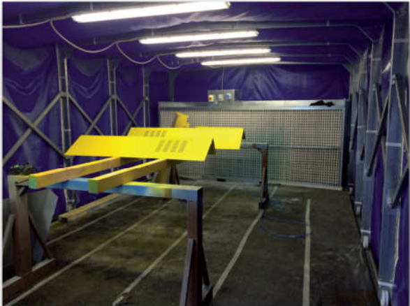
Cabine di sabbatura e verniciatura mobili.
