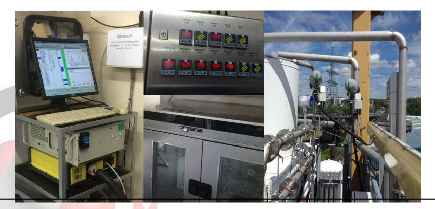
**FTIR measures:** Concentrations of  $H_2O$ ,  $CO_2$ , CO, NO,  $NO_2$ ,  $N_2O$ ,  $SO_2$ ,  $NH_3$ ,  $CH_4$ ,  $C_2H_6$ ,  $C_2H_4$ ,  $C_3H_8$ ,  $C_6H_{14}$ , Formaldehyde, MEA and TOC
