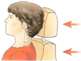
FIGURA 3-18 Se o encosto da cabeça estiver levantado, a cabeça se moverá para a frente junto com o tronco, evitando a lesão cervical.
