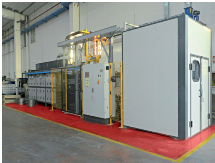
Impianto zinco lamellare.
