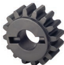
Pignone Z16 modulo 6 con protezione per cremagliera
