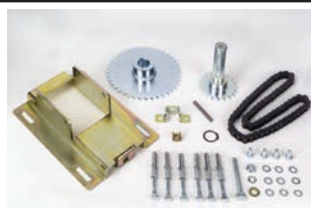
Il Kit rinvio applicazioni "Fuori asse" R. 1:2,0 comprende: Piastra di fissaggio del motoriduttore comprensiva di sistema di regolazione tensione a catena Pignone Z20 con albero per installazione sul motoriduttore Pignone Z40 con albero per installazione sull'albero del portone sezionale Catena di rinvio
