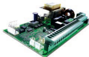
Scheda elettronica JE275 gestione fino a max 1 dissuasore M30
