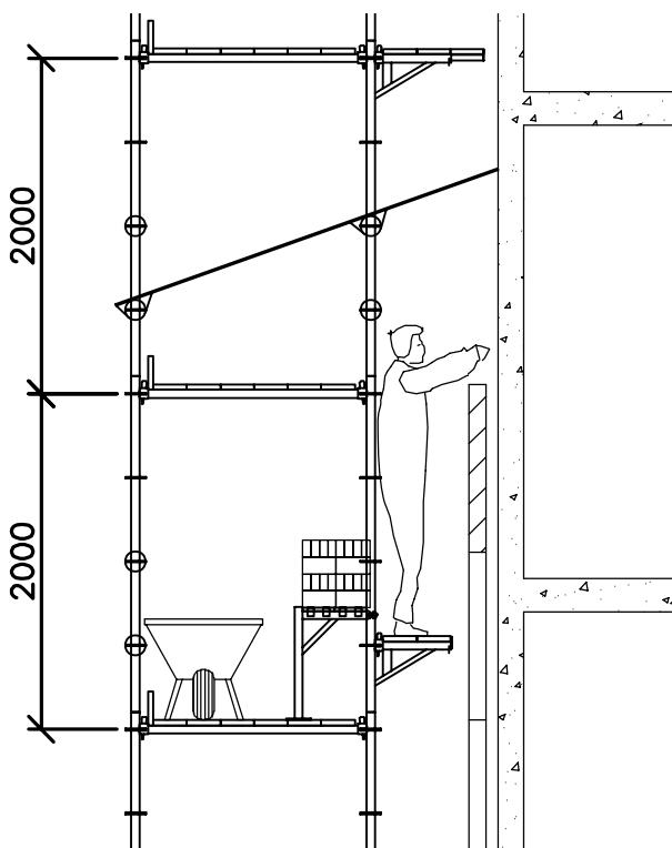
De tussenkap is in enkele minuten met behulp van spanriempjes en/of elastieken te monteren. Met het aanbrengen kan dus gewacht worden tot het moment van naderende neerslag of aan het einde van de werkdag. Het af te schermen gebied kan zich beperken tot het gedeelte van de gevel waar op dat moment de werkzaamheden plaatsvinden.
