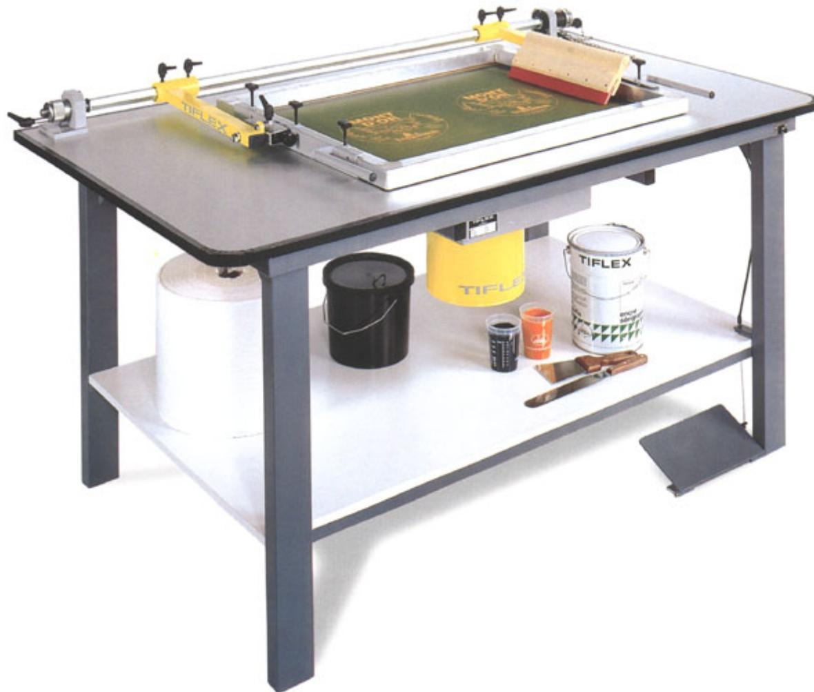
La Precima è una macchina piana equipaggiata di un piano aspirante, permette di stampare manualmente tutte le superfici o oggetti con formati di stampa max. di 40x60 cm o di 60x80 cm, fino a 12 cm di spessore per il 1° modello e 14 cm per il 2° modello.
