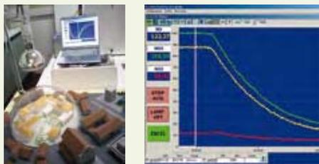
Misura in laboratorio dell'abbattimento di NO<sub>2</sub>. Il grafico mostra l'immediatezza dell'abbattimento.
