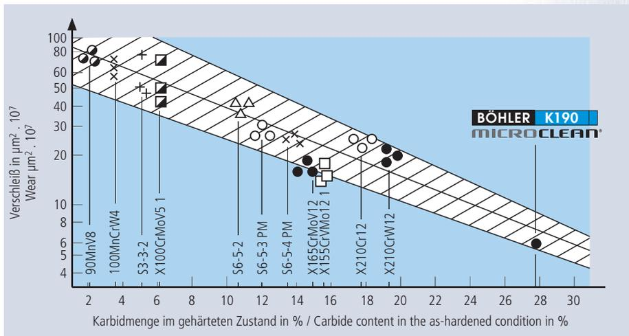
Verschleiß von Schneidstempel und Matrize in Abhängigkeit von der Karbidmenge der gehärteten Werkzeugwerkstoffe der Stanztechnik.
