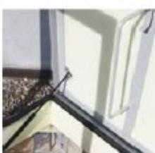
Coperchio in lamiera zincata pressopiegata sp. 15/10 con trattamento di verniciatura a fuoco in epossipoliestere colore grigio RAL 9007. Coibentazione in poliestere sp. 20 mm. Ammortizzatori, guarnizioni in battuta perimetrale, chiusura a catenaccio e cerniere in acciaio.
