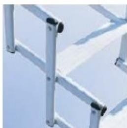
Struttura in tubolare ovale 36x18 sp. 1,2 mm verniciato a fuoco epossipoliestere e perni in acciaio trafilati diametro 10 mm
