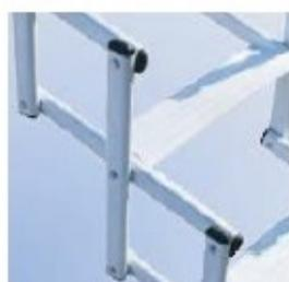
Struttura in tubolare ovale 36x18 sp. 1,2 mm verniciato a fuoco epossipoliestere e perni in acciaio trafilati diametro 10 mm
