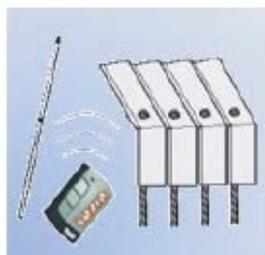
Kit di montaggio comprensivo di radiocomando e centralina, bastone per sblocco manuale e barre filettate di ancoraggio con staffe.
