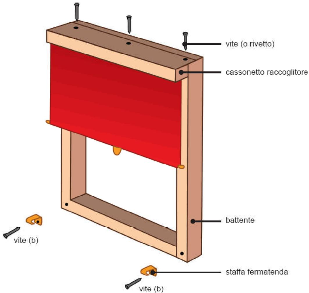
Fissare il cassonetto raccoglitore sulla parte esterna alta del battente con le apposite viti. Per il modello "BC" forare dei buchi  $\varnothing 4/4,5$  poi fissare con i rivetti. Svitare le viti (b) e fissare negli stessi fori le staffe fermatenda.
