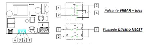
Collaudare il funzionamento per verificare se i collegamenti sono stati eseguiti correttamente e se il motore gira nel senso desiderato; in caso contrario invertire la posizione dei fili 1 e 2.
