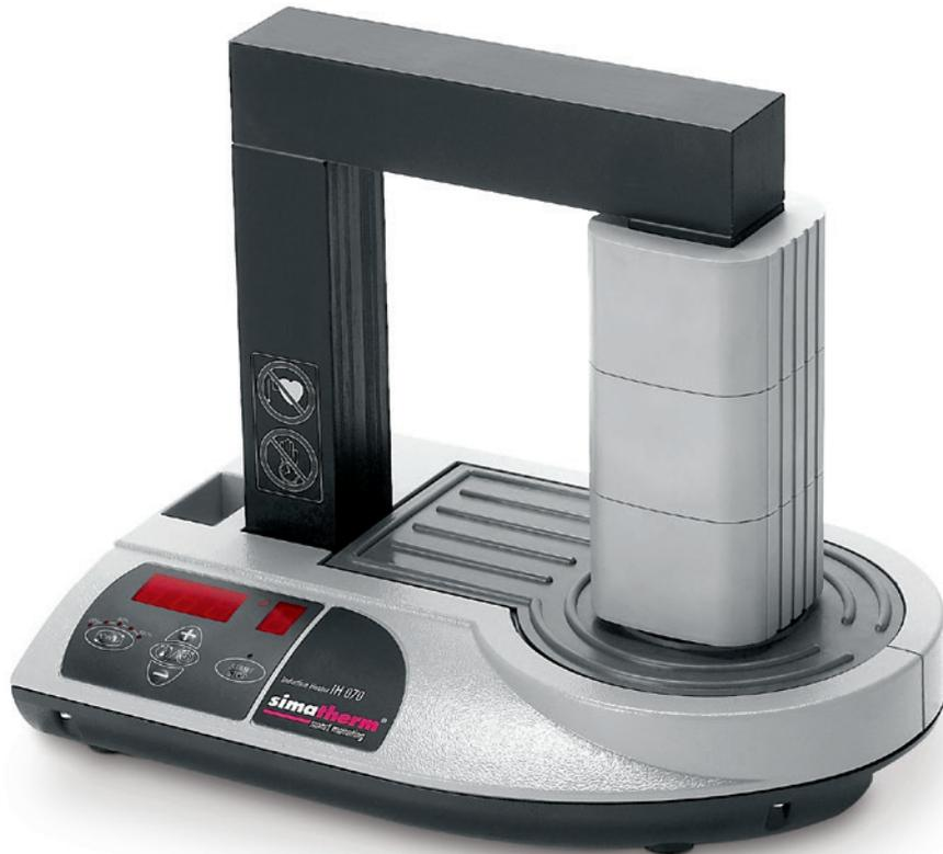
Il riscaldatore ad induzione simatherm è adatto per riscaldare cuscinetti di media taglia e altri particolari anulari metallici con foro fino a 400 mm e una sezione di 405 x 205 mm. Con integrato un sistema di controllo per lavorare in modalità tempo e temperatura, i cuscinetti possono essere riscaldati alla temperatura prescritta di 110°C mentre altri particolari anulari metallici possono essere riscaldati fino a 400°C.
