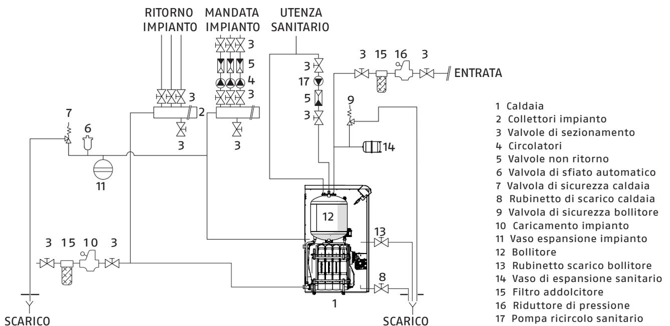
Il circuito sanitario deve essere completato con un vaso d'espansione di adeguata capacità ed una valvola di sicurezza (max 6 bar), collegata direttamente all'accumulo. La scelta e l'installazione dei componenti dell'impianto sono demandati per competenza all'installatore, che dovrà operare secondo le regole della buona tecnica e della legislazione vigente.
