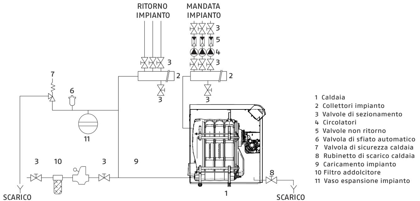
SCHEMA DI PRINCIPIO - IMPIANTI PER RISCALDAMENTO E PRODUZIONE DI ACQUA SANITARIA - GITRÈ B/100 LN
