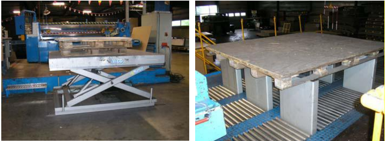
Figuur 3 Bij het stapelen van producten op een pallet die op de grond staat moet men in het begin ver voorover bukken. Door de pallet te plaatsen op een schaarheftafel (foto links) of een palletlift (foto rechts) kan de werknemer de werkhoogte zelf aanpassen, zodat bukken niet meer nodig is.
