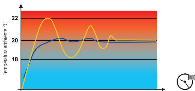
La funzione modulante di ROMEO consente una modulazione della potenza della caldaia man mano che si raggiunge il valore della temperatura ambiente impostato. Ciò migliora la qualità del comfort eliminando i picchi di calore con un conseguente risparmio energetico.
