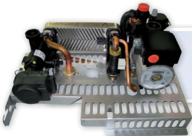
Il gruppo acqua è preassemblato su di una griglia, a sua volta fissata al telaio della caldaia. Gli organi del circuito idraulico sono scelti da produttori di primaria importanza ed uniti assieme tramite uno stabile sistema di fissaggio con clip di facile estrazione. Tale accorgimento facilita le operazioni di manutenzione sui componenti medesimi.
