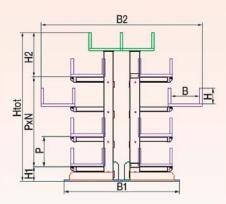
Magazzino con due file di contenitori con possibilità di accesso da due lati.
