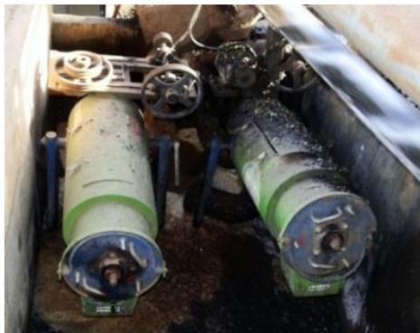
Figura 49 - Ecofiltros erroneamente instalados na primeira saída da água de processamento.
