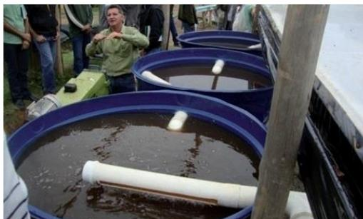
Figura 44 - Sistema de limpeza da água do processo de processamento, com detalhes das caixas de decantação.
