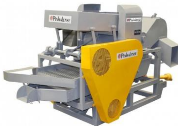
Figura 4 - Abanadora para café produzida pela Pinhalense.
