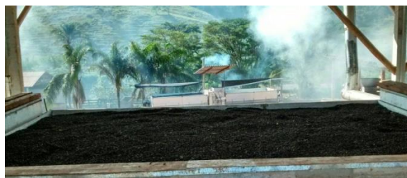
Figura 175 - Poluição ambiental devido a fornalha operada inadequadamente com queima de palha de café.
