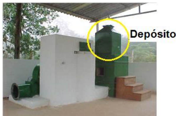
Figura 179 - Fornalha com depósito de combustível (carvão ou briquet) para secagem com queima direta do combustível.
