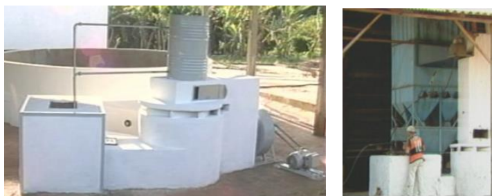
Figura 222 - Secadores com adaptação da fornalha com lenha com combustão descendente.
