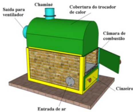
Figura 199 - Fornalha completa e seus componentes, como combustão e cinzeiro (vista anterior).
