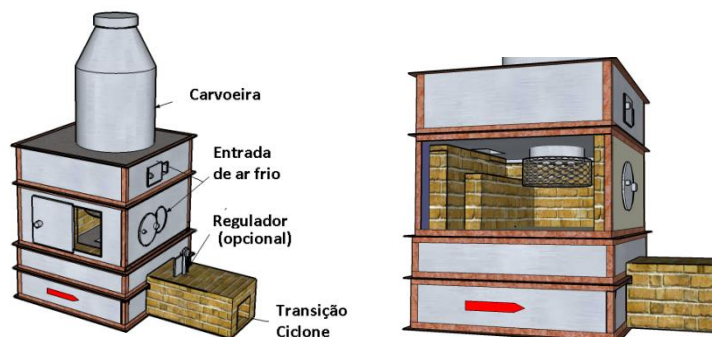
Figura 244 - Configuração da fornalha com os cinco módulos montados e parafusados e detalhes da câmara de combustão com a grelha acoplada à carvoeira.
