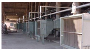
Figura 183 - Linha de vapor e trocadores de calor ar/vapor empregados na secagem de café.
