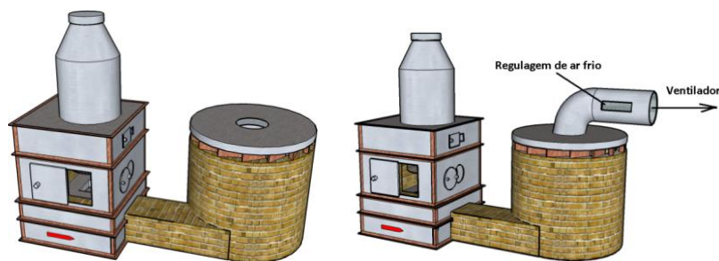
Figura 245 - Detalhes da fornalha com ciclone e duto de ligação com o ventilador
