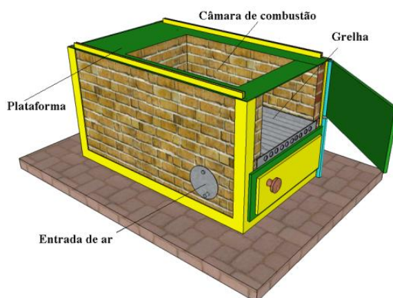
Figura 194 - Base da fornalha pronta para receber o trocador de calor.
