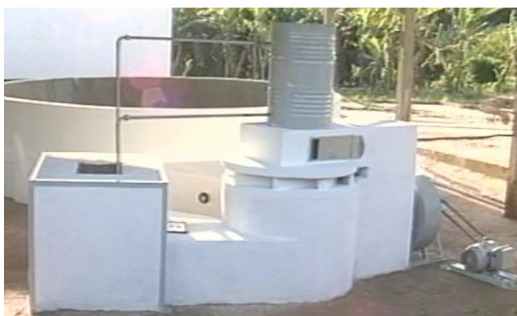
Figura 210 - Fornalha a lenha com aquecimento direto e combustão paralela descendente.
