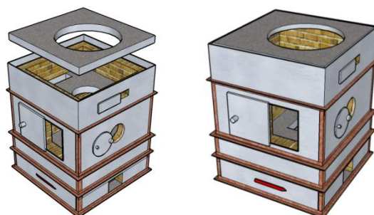
Figura 242 - Módulo 3 ou câmara de combustão recebendo a laje e pronto para receber o módulo 4.
