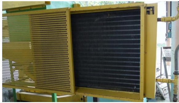
Figura 208 - Radiador com sistema de proteção usado para transferência de calor para o fluido frio, para a fornalha da Figura 203.
