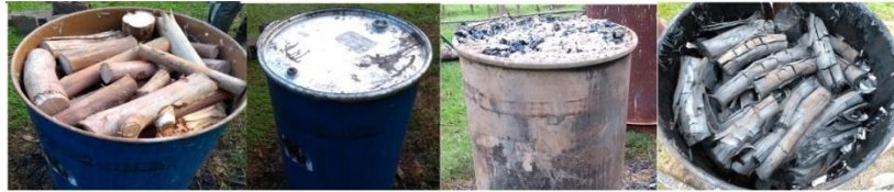
Figura 258 - Detalhes do carregamento até a produção do núcleo de carbonização.
