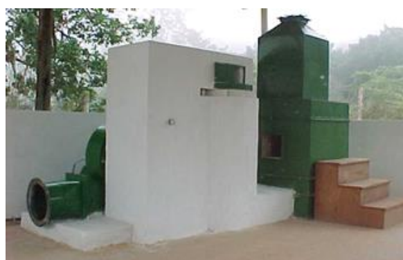
Figura 211 - Fornalha a carvão vegetal com aquecimento direto e combustão em fluxos cruzados.
