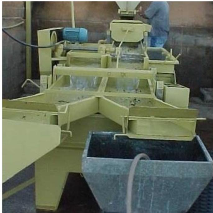
Figura 21 - Sistema mecânico para lavagem e separação hidráulica do café.
