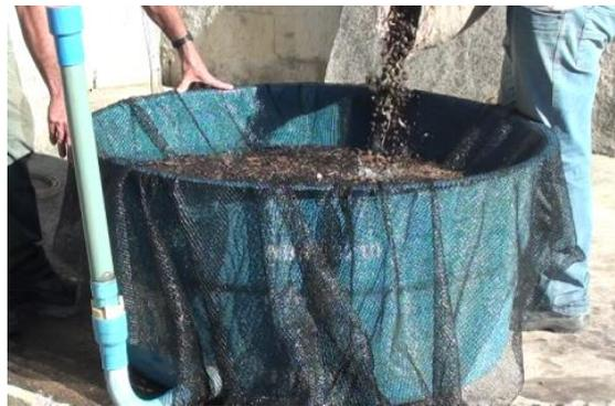
Figura 25 - Lavador rústico para café, utilizando caixa-d'água e tela sombrite.
