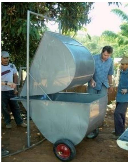
Figura 23 - Lavador móvel com sistema basculante para descarga do café cereja.
