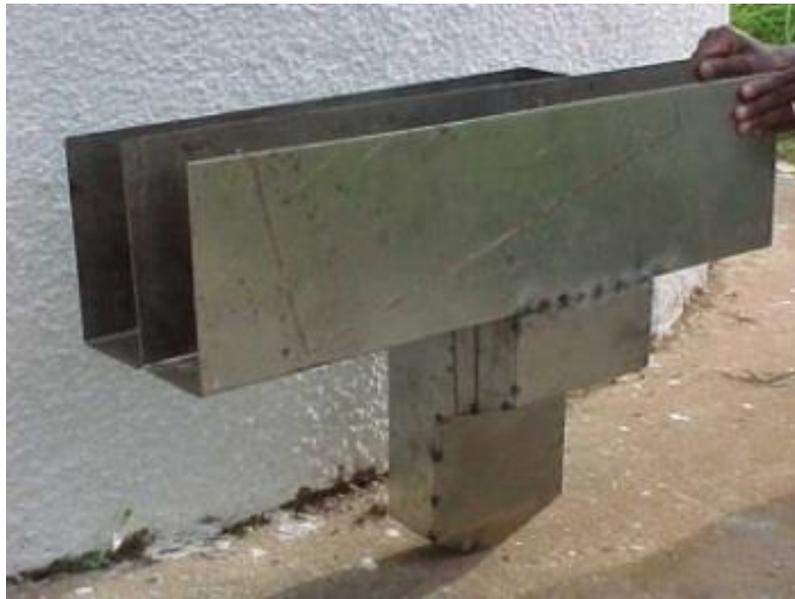
Figura 36 - Calha de separação do lavador Maravilha.
