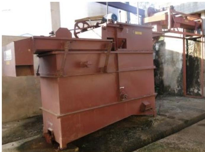
Figura 22 - Modelo de lavador mecânico que atende à necessidade da cafeicultura familiar.
