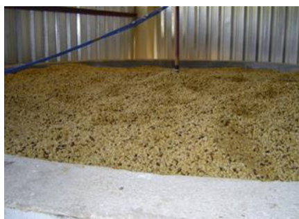
Figura 155 - Secagem complementar de café em pergamimho em silo secador.
