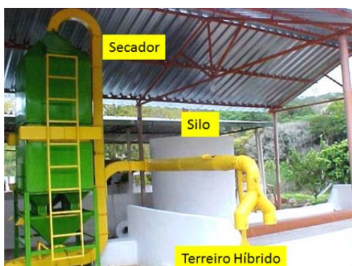
Figura 156 - Combinação terreiro secador e secador mecânico para secagem de café recém-saído do descascador.
