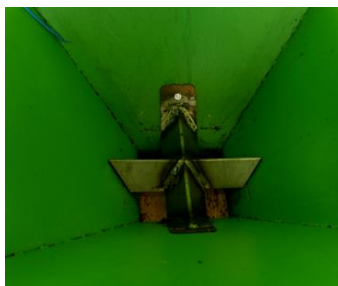
Figura 124 - Detalhe do posicionamento da cruzeta na moega de homogeneização.
