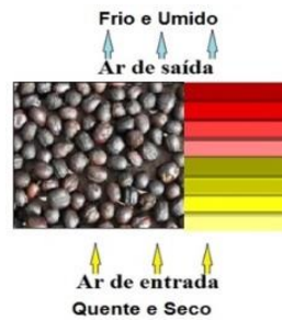
Figura 91 - Comportamento do ar de secagem em secador de camada fixa.
