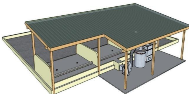
Figura 66 - Terreiro híbrido construído acima do nível do terreiro convencional, sob cobertura permanente.
