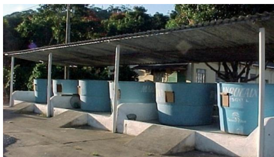
Figura 81 - Secador híbrido trabalhando com seis caixas, para secagem de lotes individualizados.
