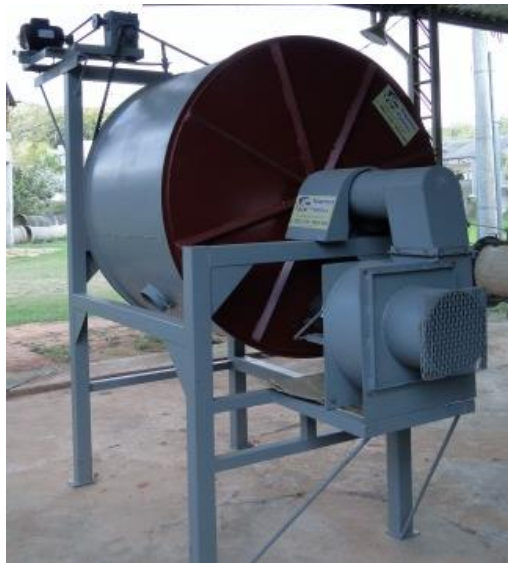
Figura 135 - Vista do secador rotativo intermitente, baseado no protótipo da Figura 134.
