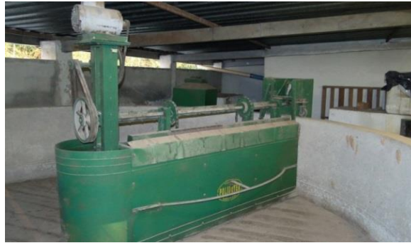
Figura 84 - Sistema revolvente para o secador em camada fixa.
