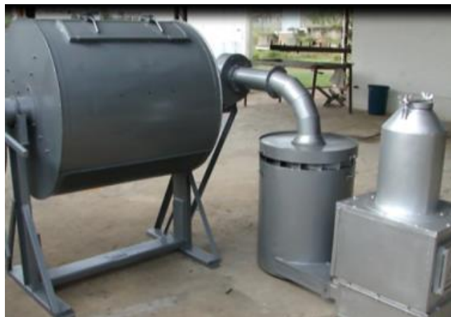
Figura 134 - Vista geral do protótipo do novo secador rotativo com rotação intermitente.
