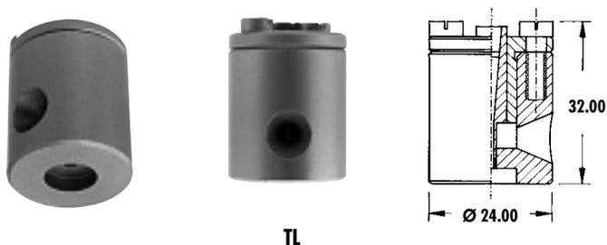
Ugello speciale utilizzato sui telai per la tessitura di fibre sintetiche. La peculiarità di questo ugello consiste nella capacità di trascinare il filo per una distanza di oltre due metri all'interno di un getto d'acqua avente la forma di un tubo.
