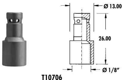
La particolare proiezione del getto circolare e l'uso ad alte pressioni da 30 a 200 bar fanno avanzare l'ugello automaticamente all'interno del tubo consentendo un ottimo lavaggio con forte impatto.
