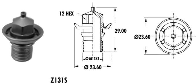
La punta liquido tipo Z131S viene usata su pistole per aerografi ed è disponibile con una serie di fori e di portate diverse.
