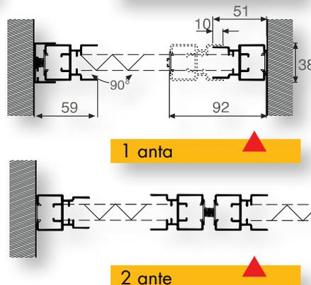
Consigliamo sempre l'applicazione della plissé con il profilo compensatore perché questo facilita il montaggio e lo smontaggio anche in presenza di murature imperfetta.
