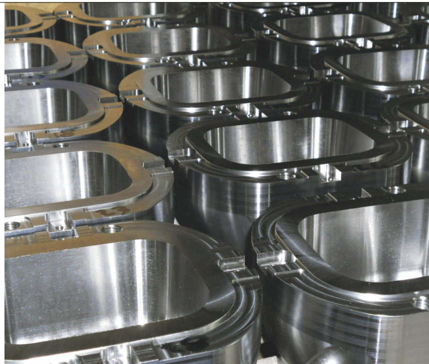
Stampi matrice in acciaio 431, torniti e fresati.
