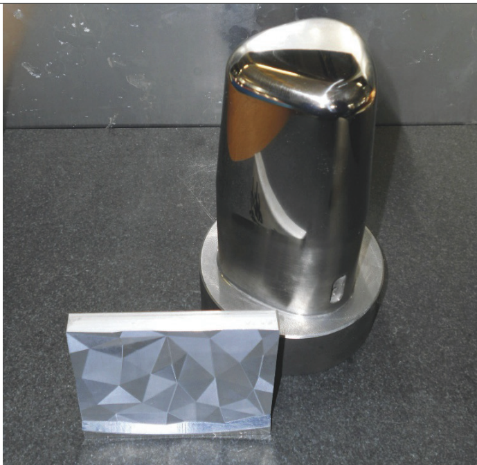
Stampo maschio lucidato realizzato in ghisa sferoidale con riporto di metallizzazione per formatura interno bicchiere da whisky ed esempio di decorazione a diamante realizzata su serie di articoli da tavola.
