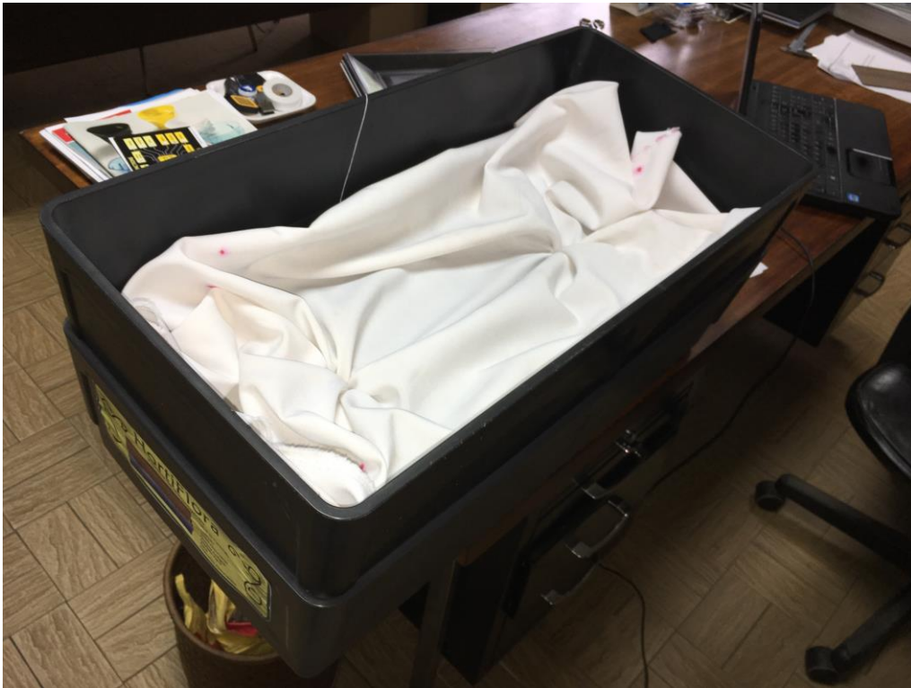
Montagem da floreira com tecido absorvente. Notar o tecido encorilhado na em dois pontos, penetrando na caixa inferior, depósito de água.
