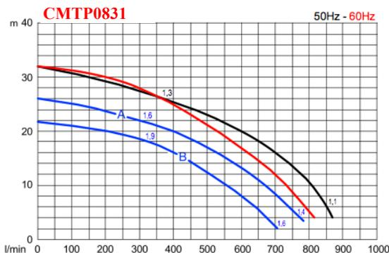
Riferimenti per le curve: acqua a temperatura ambiente / Curve references: water at room temperature
