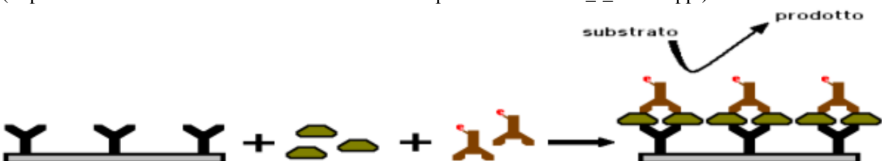
Figura 6 – Rappresentazione schematica del metodo ELISA sandwich ( http://www.uniroma2.it/didattica/LabBioanalitica/deposito/bioanalitica_-_ELISA.ppt )
