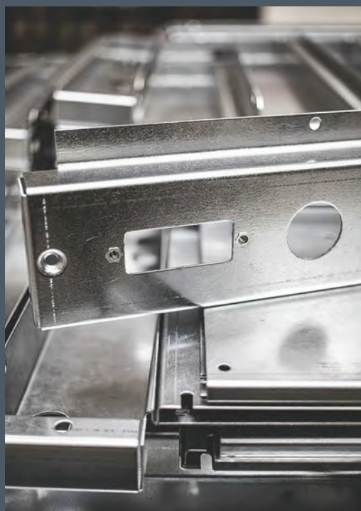
Scatolato in lamiera zincata, spessore 1,5 mm, con inserti filettati e imbutitura per vite conica.
