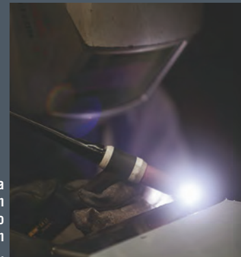
Saldatura a Tig di un quadro elettrico in AISI 304.
