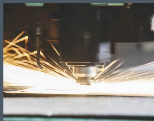
Zoom della testa del laser durante una lavorazione di piercing.
