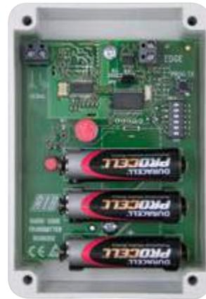
ACG6202 TRASMETTITORE RADIO RED per costa meccanica o elettrica - da alimentare con 3 batterie stilo tipo AA da 1,5V non incluse **152 €**
