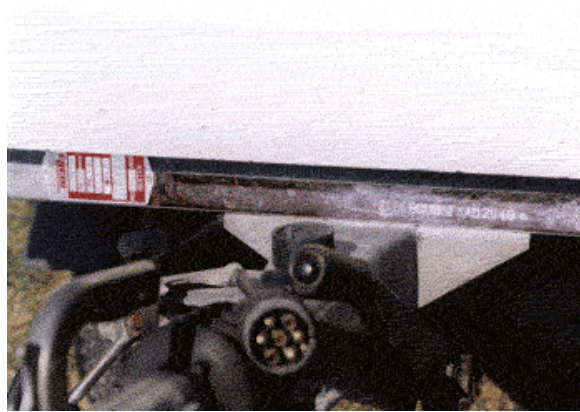
Targhetta del costruttore, numero di telaio, timone e giunto elettrico (zona anteriore del carrello)
