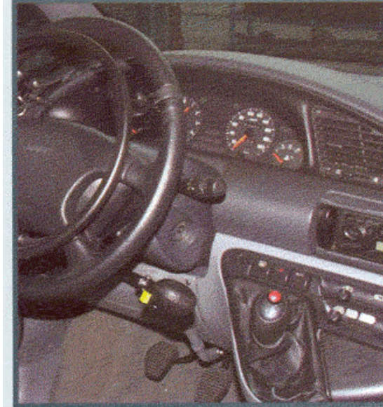
Adattamenti per disabili: acceleratore al volante e freno a lungo braccio
