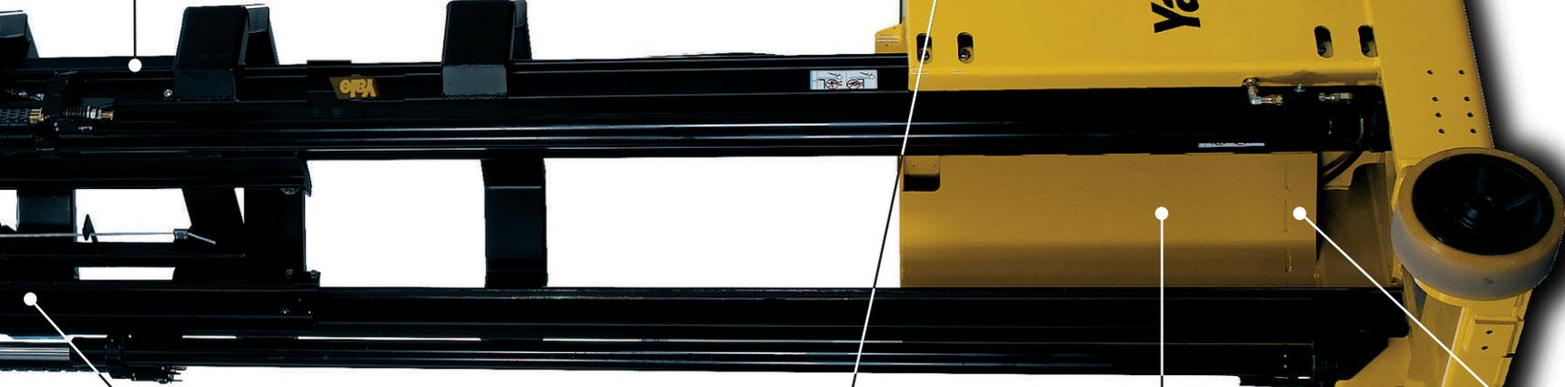
I montanti Yale duplex o triplex di tipo tri-form e quad-form hanno una rigidità e una stabilità eccellenti, con altezze di sollevamento che possono superare i 16 metri di altezza delle forche.
