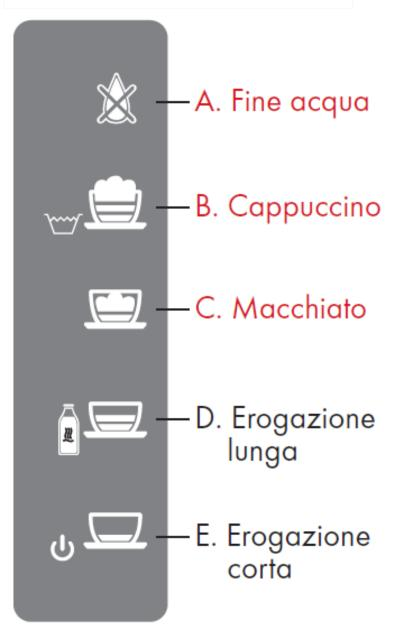
Quando la spia fine acqua lampeggia lentamente, il serbatoio è vuoto. La mancanza acqua nel serbatoio viene anche segnalata sul display e con un segnale acustico. La macchina è dotata di un sensore che inibisce il funzionamento in caso di mancanza acqua.
